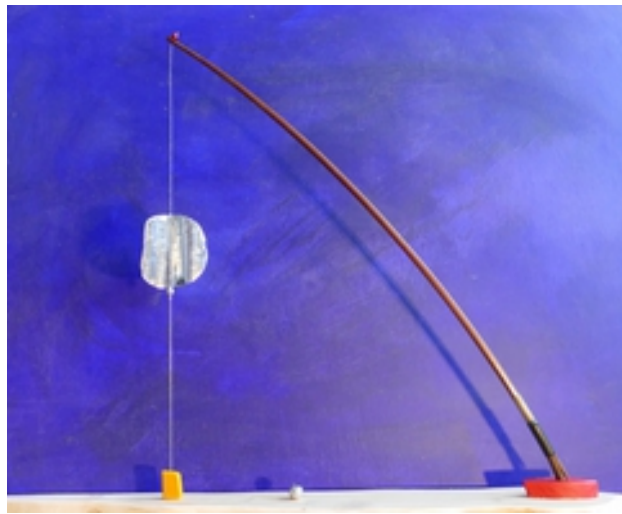
Seilverankerung senkrecht unter oberem Ende des Bogens
